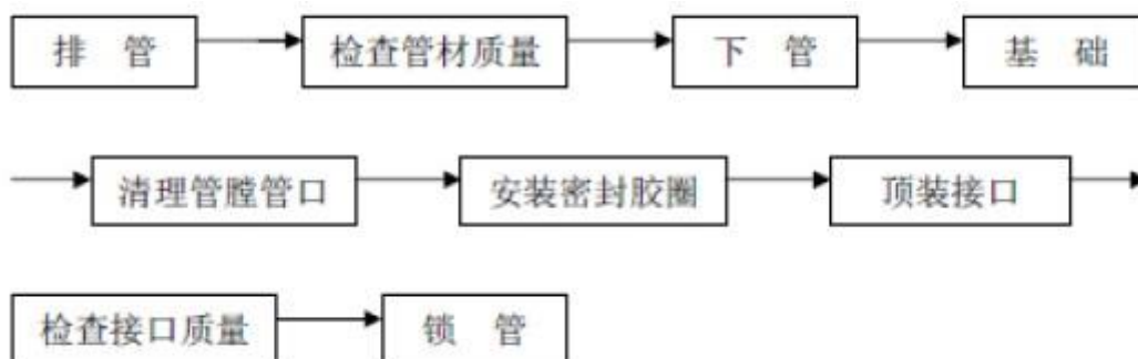
图 5-2 管道安装工艺流程图
