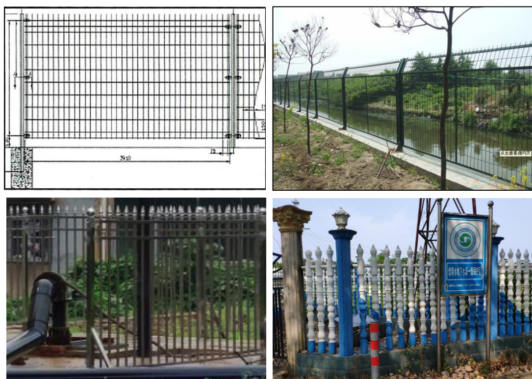
图 4-7 饮用水源保护安全围栏结构示意图和样图
