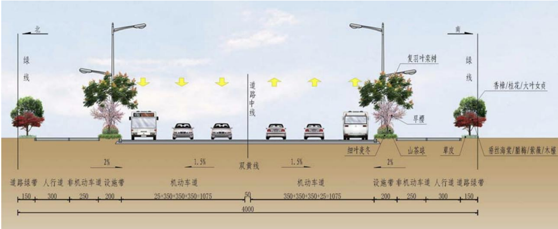
图 2.9-2 拓宽路段景观横断面设计图
